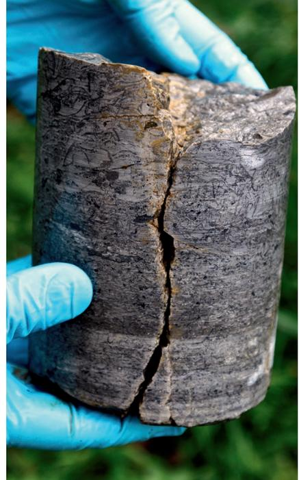
Foto oben: Bohrkernprobe einer Schillkalkbank (Oberer Muschelkalk). Die durch Verkarstung erweiterten Klüfte stellen Fließpfade des Grundwassers dar.
